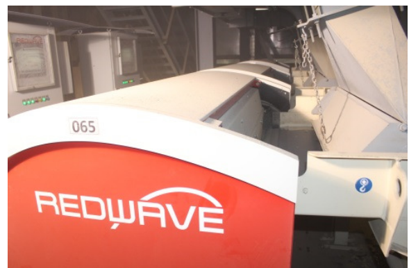
Bild: REDWAVE Sortiermaschinen zur Farbsortierung und Störstoffabscheidung
