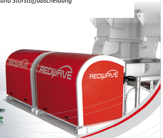
Bild: REDWAVE Sortiermaschinen zur Farbsortierung und Störstoffabscheidung
