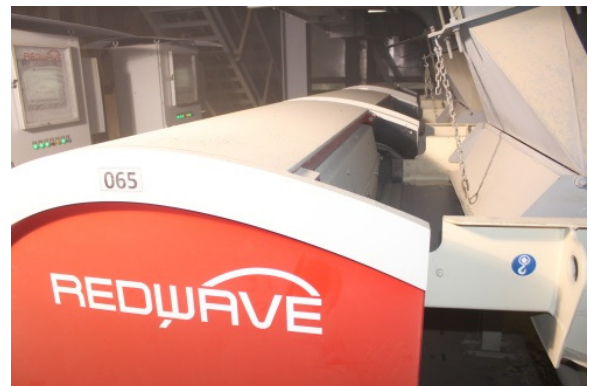
Bild: REDWAVE Sortiermaschinen zur Farbsortierung und Störstoffabscheidung
