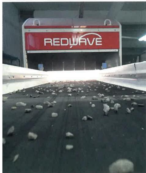
**PLATZSPAREND ANGE-DOCKT:** Der Sortierer Redwave 1300 S 1CA reinigt seit 2013 Quarzkiese der Körnung 20/80 mm zuverlässig von Verunreinigungen bei einem Stundendurchsatz von 60 t.
