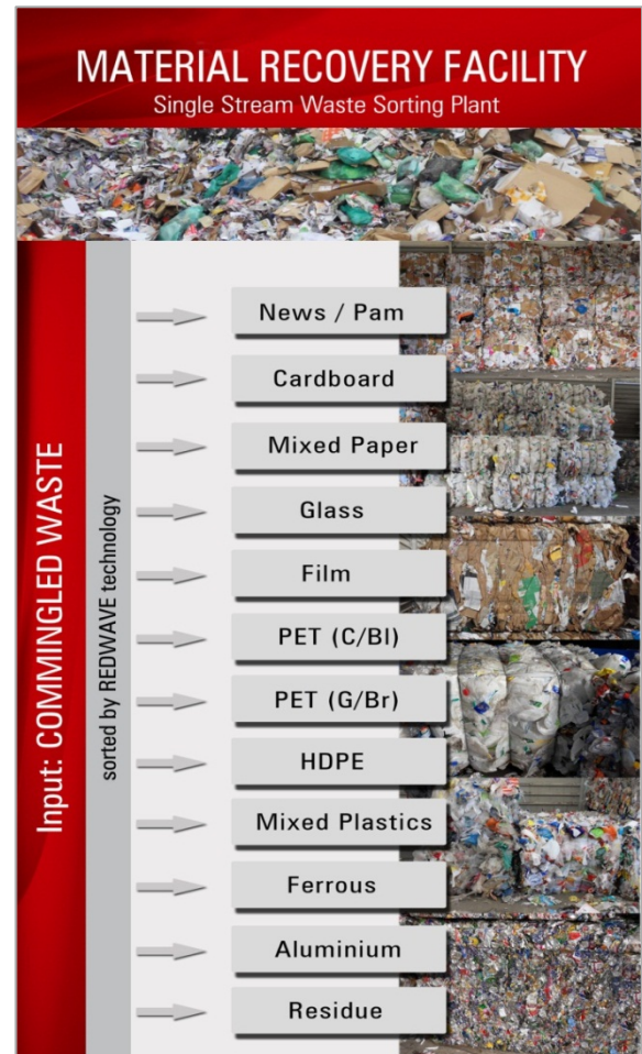
Das Aufgabematerial wird in 12 verschiedene Fraktionen unterteilt
