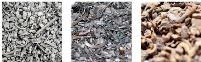
Die innovative Sortiermaschine REDWAVE XRF fine revolutioniert die Aufbereitung von feinem Material im Bereich Metallrecycling. Ein Mix aus Nichteisenmetallen ab einer Größe von 4 mm wird zuverlässig erkannt und sortiert, um daraus hochwertige und reine Produkte wie Kupfer, Messing, Zink sowie Edelmetallfraktionen höchster Qualität aufzubereiten. Durch die Verwendung von XRF-Sortiertechnik werden Metalle in großem Umfang effizient sortiert und wiedergewonnen.
